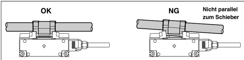
Den Tisch verschieben, sodass sich der Kopf in der Nähe des Maßstabhalters auf der gegenüberliegenden Seite befindet, und dann die Sechskantschrauben ①, ② und ③ in dieser Reihenfolge auf die gleiche Weise sachte anziehen.
